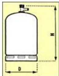
***UTILISER DES RECIPIENTS GAZ DE 13 KG (BUTANE OU PROPANE) D'UNE HAUTEUR MAXIMALE DE 615 MM SUR UN DIAMETRE EXTERIEUR DE 310 MM***
